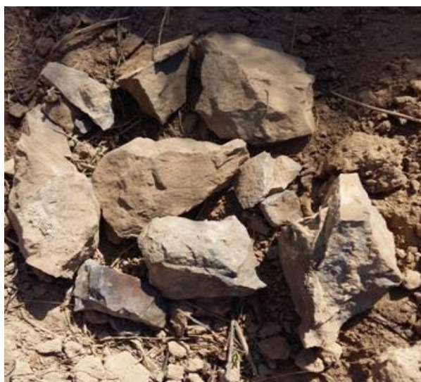
Рисунок 3 – Разрушение железобетонного блока составом \text{NH}_4\text{NO}_3\text{-C-nAl} [29]
