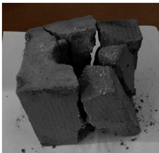
Рисунок 52 – Разрушение железобетонного блока составом \text{NH}_4\text{NO}_3 -ПЭ- Mg
