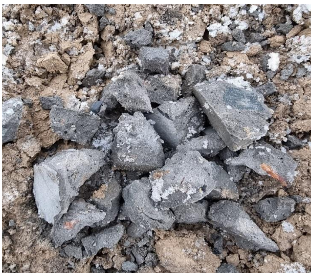
Рисунок 58 – Разрушенный монолитный бетонный блок зарядом №3 (ВВ Senatel Magnum)
