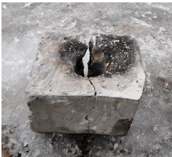
Рисунок 54 – Образец после испытаний, разрушенный составом ПХА-ПЭ-Mg
