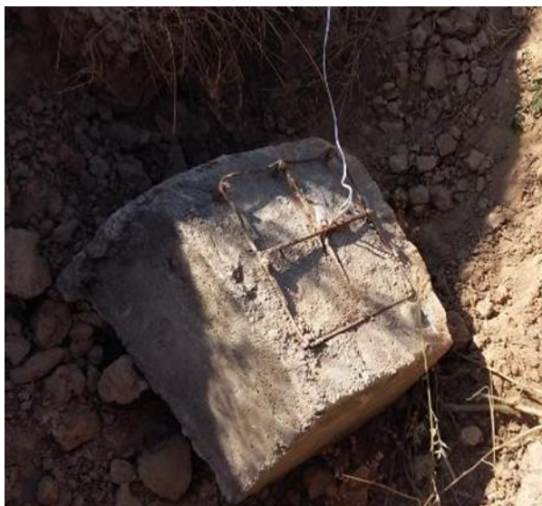
Рисунок 2 – Железобетонный блок с зарядом \text{NH}_4\text{NO}_3\text{-C-Al} [29]
