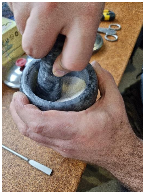
Рисунок 49 – Процесс подготовки образцов для проведения испытания на чувствительность к удару
