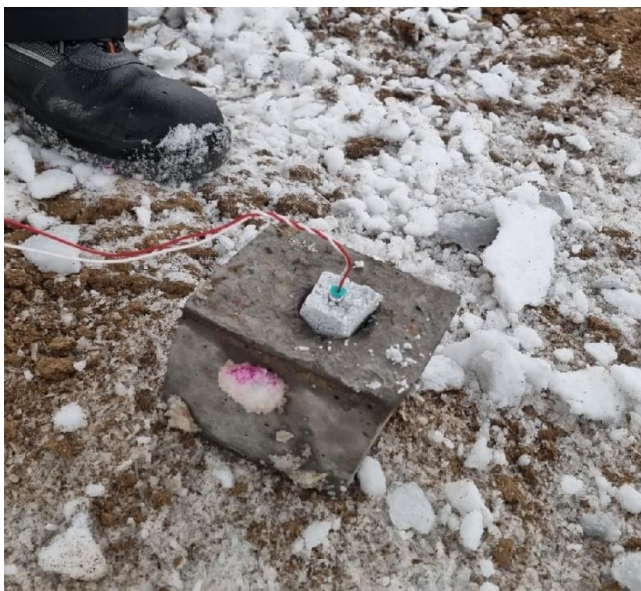
Рисунок 57 – Монолитный бетонный блок с зарядом №3 (ВВ Senatel Magnum)
