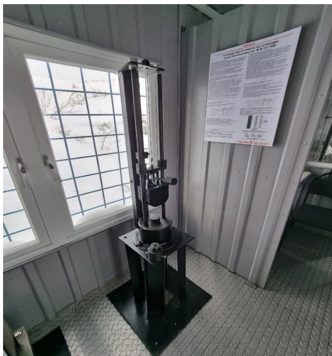
Рисунок 18 – Копер Каста-Казлова для определения чувствительности составов к удару
