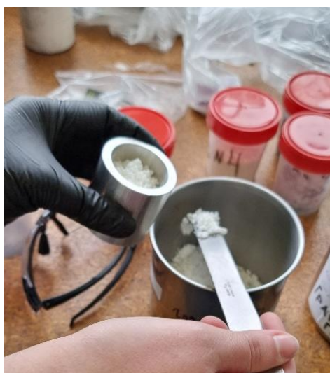
Рисунок 45 – Определение плотности составов на основе НА, ПХА
