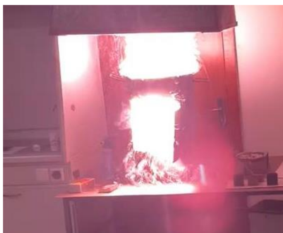
Рисунок 27 – Фрагмент горения составов \text{NH}_4\text{NO}_3 -ПЭ-Mg
